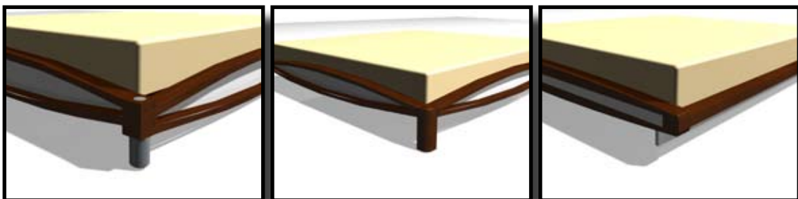
OBR.9: | ALTERNATÍVY SPÁJANIA NOHY S RÁMOM POSTELE | AUTOR: ALENA KAJANOVÁ | PREDMET : DIZAJN KONŠTRUKČNÉHO DETAILU
